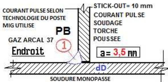
Procédé de soudage : **MIG PULSE FIL MASSIF SOUS GAZ INERTE**
